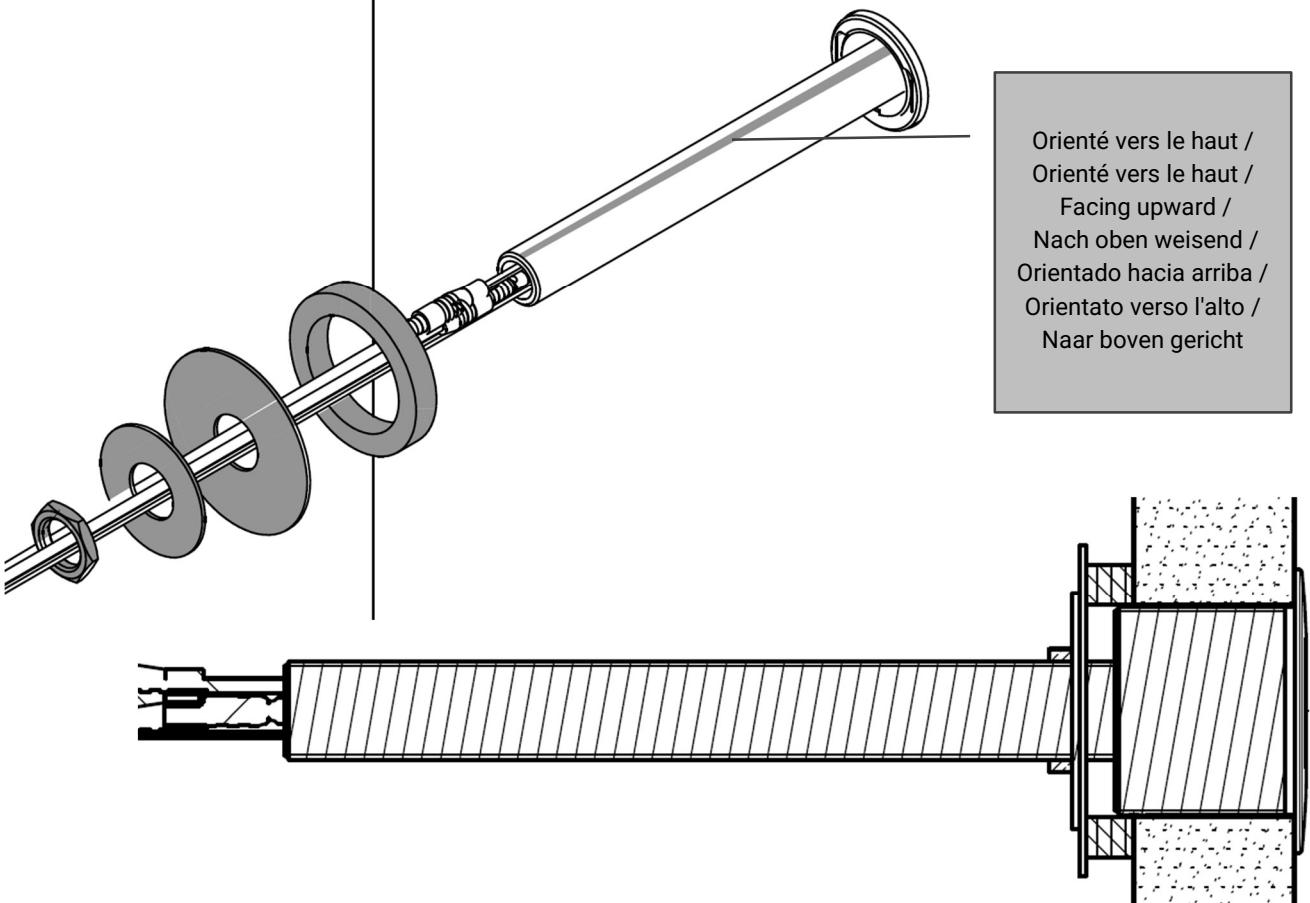
**3-2.C / Recoupe de la queue G1/2 si nécessaire / Cutting of the tube G1/2 if necessary / Rohr G1/2 schneiden wenn nötig / Corte de la barra G1/2 si es necesario / Taglio del tubo G1/2 se necessario / De buis G1/2 afsnijden, indien nodig**
