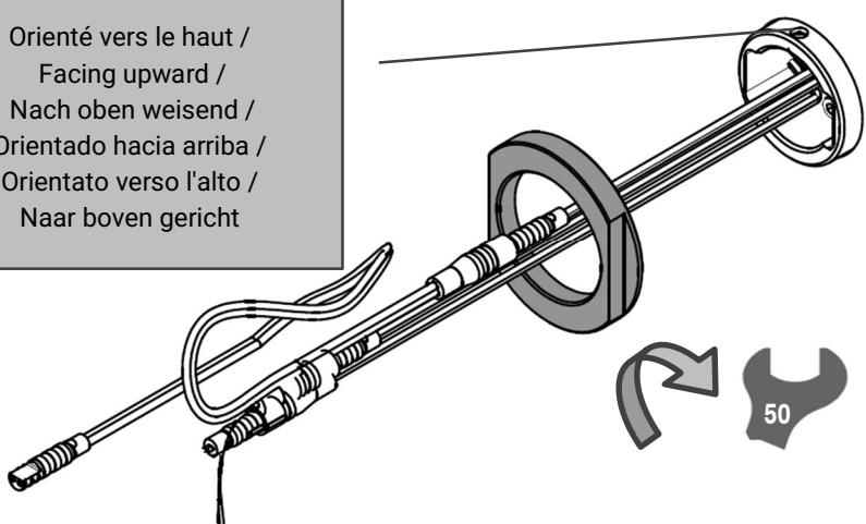
**Version TC de 30 à 200 mm / Version cross-partition 30 to 200 mm / Für ZW-Montage zwischenwand von 30 bis 200 mm / Versión través de tabique de 30 a 200 mm / Versione tramite tramezzatura da 30 a 200 mm / Voor wanddoorvoer, wanddikte van 30 tot 200 mm**
