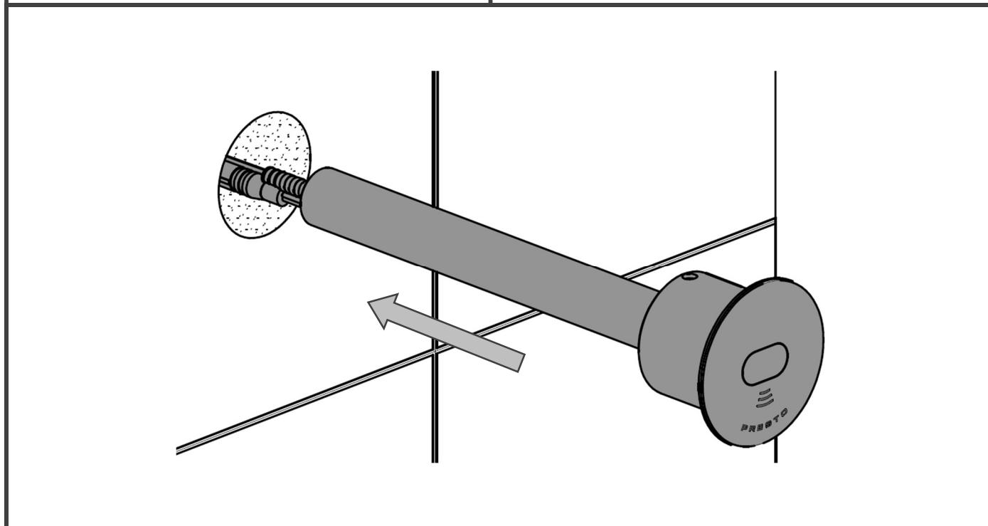
Si cloison percée à Ø 44 mm puis Ø 22 mm / If partition drilled at Ø 44 mm then Ø 22 mm / Wenn die Trennwand bei Ø 44 mm gebohrt wird, dann Ø 22 mm / Si tabique perforado a Ø 44 mm y luego a Ø 22 mm / Se la partizione è forata a Ø 44 mm allora Ø 22 mm / Als scheidingswand op Ø 44 mm geboord is, dan Ø 22 mm
