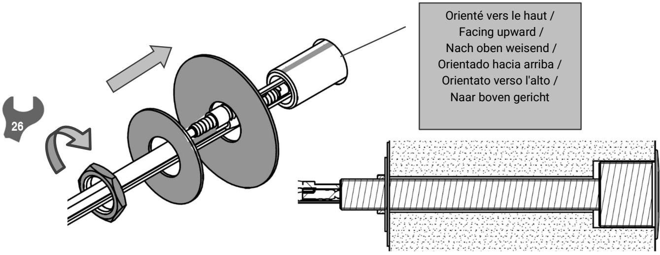
Si cloison percée Ø 44 mm sur toute sa profondeur et ép > 80 mm / If partition drilled at Ø 44 mm over its entire depth and thickness > 80 mm / Wenn die Trennwand bei Ø 44 mm gebohrt ist über die gesamte Tiefe und Wandstärke > 80 mm / Si tabique perforado Ø 44 mm en toda su profundidad y espesor > 80 mm / Se tramezzo forato Ø 44 mm su tutta la sua profondità e spessore > 80 mm / Als scheidingswand op Ø 44 mm geboord is over de gehele diepte en wanddikte > 80 mm
