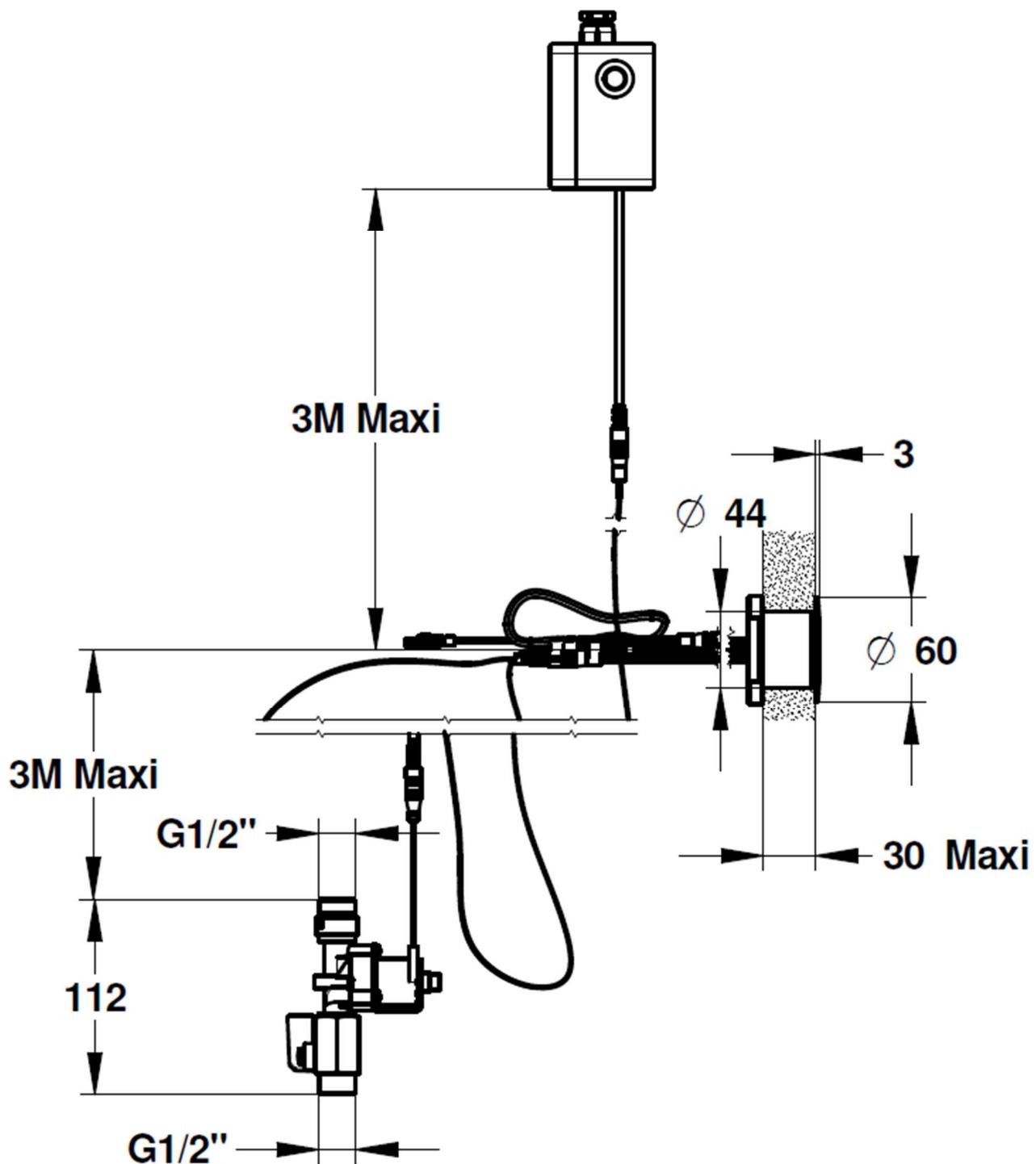
**Version TC de 30 à 200 mm / Version cross-partition 30 to 200 mm / Für ZW-Montage zwischenwand von 30 bis 200 mm / Versión través de tabique de 30 a 200 mm / Versione tramite tramezzatura da 30 a 200 mm / Voor wanddoorvoer, wanddikte van 30 tot 200 mm**
